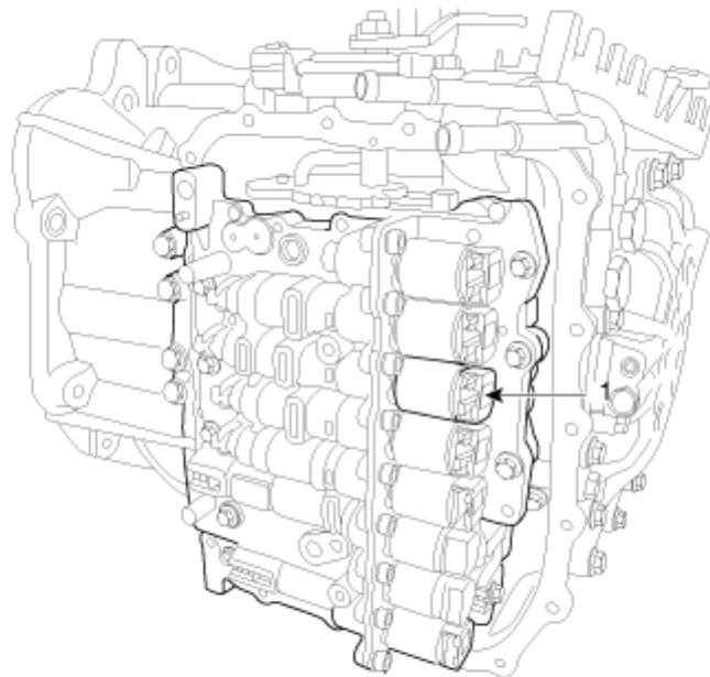
1. 2/6档制动器控制电磁阀 (26/B\_VFS)
